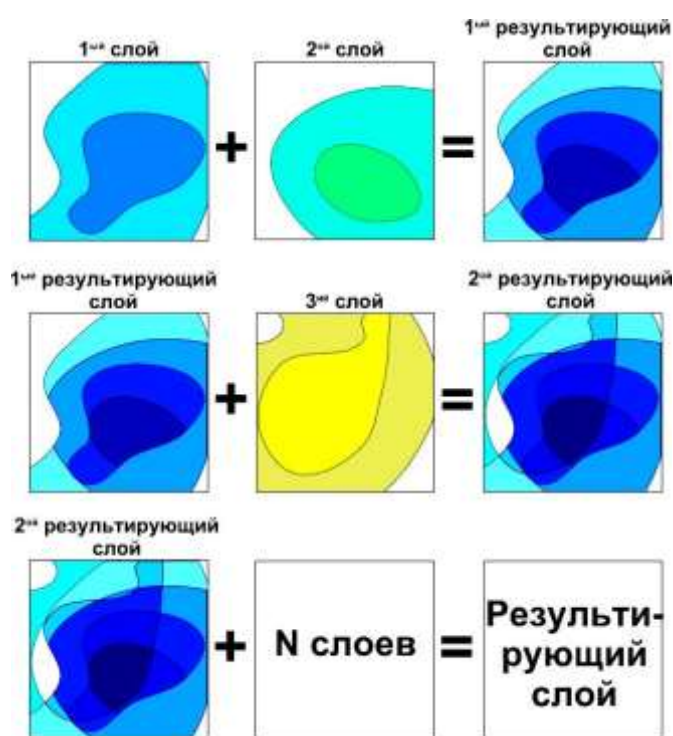
Рис. 2. Схема разрезания одного слоя другим
